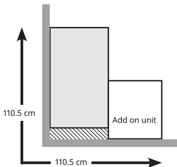
Kedalaman unit tambahan 58 cm untuk sudut dengan satu rangka berukuran 100×58 cm.
