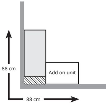
Kedalaman unit tambahan 35 cm untuk sudut dengan satu rangka berukuran 75×35 cm.
