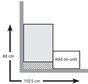
Kedalaman unit tambahan 35 cm untuk sudut dengan satu rangka berukuran 75×58 cm.
