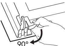
잠금 시스템을 해제하여 내부 유리 패널을 제거합니다. 두 개의 패스너를  $90^{\circ}$  돌립니다.
